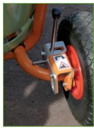
Eine Feststellbremse wird verwendet, um den Wagen bei Tätigkeiten im Gefälle zu stabilisieren.
