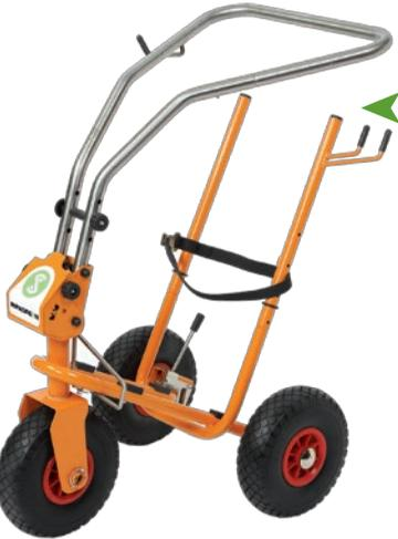
Das Ripagreen® Fahrgestell ist aus robusten und dauerhaften Materialien gebaut; Epoxidlackierte Stahlrohre für die Tragkonstruktion; rostfreie Rohr- und Stahldrähte für Fahrdeichsel und Ausrüstungen wie Bremse und Düsenorientierungseinrichtung. Allerdings wiegt es nur 12,5 kg und lässt sich in wenigen Sekunden zur optimalen Lagerung zusammenklappen.
